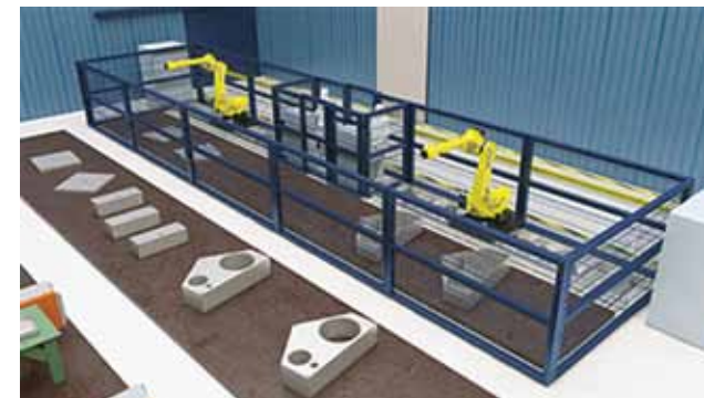
Комплекс автоматизированного сварочного оборудования для изготовления фундаментов и корпусных конструкций
